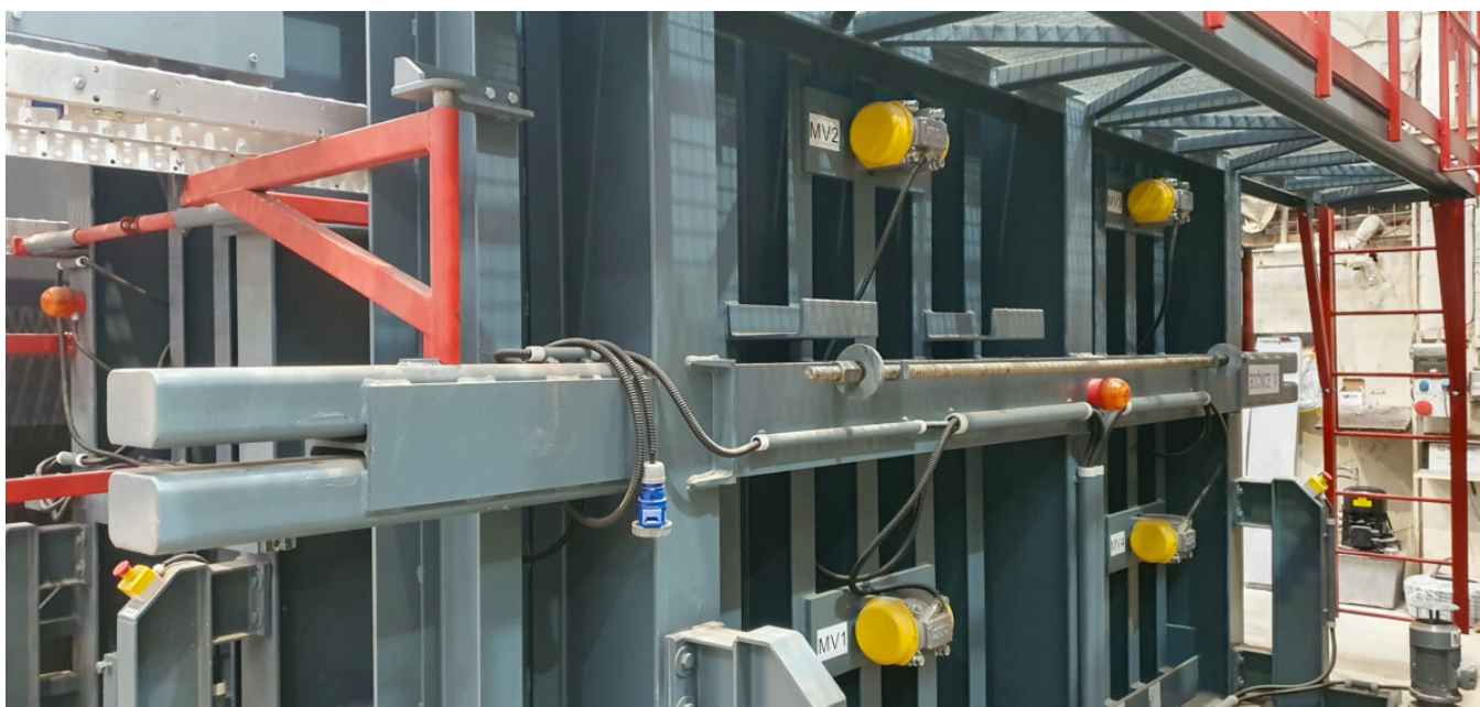
Motory příložných vibrátorů na formě
